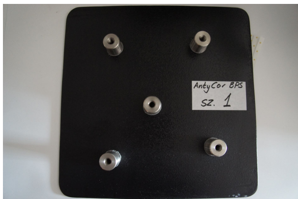
Rys. 2 Widok stalowych płytek badawczych \phi 20 mm przyklejonych do powierzchni badanej powłoki
